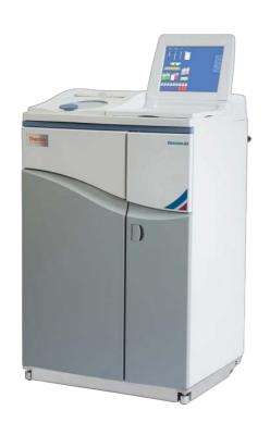
Processador automático histológico, totalmente fechado, com capacidade para 300 cassetes. Maior proteção aos espécimes, garantido através de bateria reserva para eventual falta de energia. Software interativo com ícones fáceis e operação simplificada, semelhante a um manual do usuário eletrônico.
